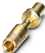
Contact à sertir, Connecteur femelle, tournés, Contact unique, diamètre de contact: 3,6 mm, zone de sertissage: 1 mm<sup>2</sup> ... 2,5 mm<sup>2</sup>, Produit de remplacement selon RoHS II sans exception 6c (Pb < 0,1 %) référence : 1241977
