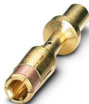
Contact à sertir, Connecteur femelle, tournés, Contact unique, diamètre de contact: 3,6 mm, zone de sertissage: 2,5 mm<sup>2</sup> ... 4 mm<sup>2</sup>, Produit de remplacement selon RoHS II sans exception 6c (Pb < 0,1 %) référence : 1241979
