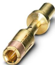
Contact à sertir, Connecteur femelle, tournés, Contact unique, diamètre de contact: 3,6 mm, zone de sertissage: 6 mm<sup>2</sup> ... 10 mm<sup>2</sup>, Produit de remplacement selon RoHS II sans exception 6c (Pb < 0,1 %) référence : 1241980
