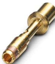
Contact à sertir, Connecteur femelle, tournés, Contact unique, diamètre de contact: 2 mm, zone de sertissage: 0,25 mm<sup>2</sup> ... 1 mm<sup>2</sup>, Produit de remplacement selon RoHS II sans exception 6c (Pb < 0,1 %) référence : 1241952
