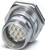
M23, Connecteur d'appareil face arrière, série: RC, droit, blindé: oui, Verrouillage à vis, Joint torique axial, Fixation centrale M25 x 1,5, Epaisseur de paroi min.: 0,8 mm, Epaisseur de paroi max.: 6,5 mm
