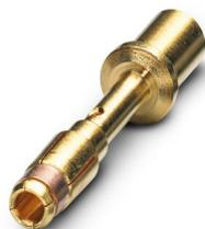
Contact à sertir, Connecteur femelle, tournés, Contact unique, diamètre de contact: 2 mm, zone de sertissage: 4 mm<sup>2</sup> ... 4 mm<sup>2</sup>, Produit de remplacement selon RoHS II sans exception 6c (Pb < 0,1 %) référence : 1241949
