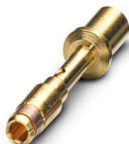
Contact à sertir, Connecteur femelle, tournés, Contact unique, diamètre de contact: 2 mm, zone de sertissage: 0,25 mm<sup>2</sup> ... 1 mm<sup>2</sup>, Produit de remplacement selon RoHS II sans exception 6c (Pb < 0,1 %) référence : 1241952
