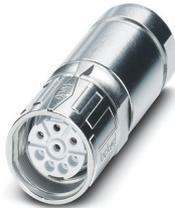
Connecteurs à câble, SPEEDCONNEC, M23, nombre de pôles: 4+3+PE, type de contact: Connecteur femelle, blindé: oui, indice de protection: IP67, plage de diamètre de câble: 15 mm .. 18 mm, nombre de pôles: 8, type de raccordement: Raccordement à sertir, Produit de remplacement selon RoHS II sans exception 6c (Pb < 0,1 %) référence : 1243174
