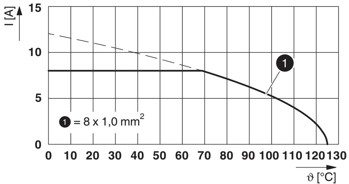
I = intensité,  $\vartheta$  = température ambiante, 8x 8 A
