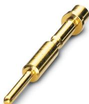
Contact à sertir, Mâle, tournés, Contact unique, diamètre de contact: 1 mm, zone de sertissage: 0,06 mm<sup>2</sup> ... 0,25 mm<sup>2</sup>, Produit de remplacement selon RoHS II sans exception 6c (Pb < 0,1 %) référence : 1243215
