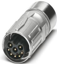
Connecteurs à câble, droit, SPEEDCONNEC, M17, nombre de pôles: 17, type de contact: Mâle, blindé: oui, indice de protection: IP67, plage de diamètre de câble: 9 mm ... 11,2 mm, nombre de pôles: 17, type de raccordement: Raccordement à sertir, Produit de remplacement selon RoHS II sans exception 6c (Pb < 0,1 %) référence : 1243278
