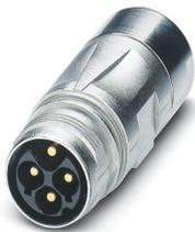
Connecteur prolongateur, droit, Pour verrouillage standard et SPEEDCON, M17, nombre de pôles: 3+PE, type de contact: Mâle, blindé: oui, indice de protection: IP67, plage de diamètre de câble: 9 mm ... 11,2 mm, nombre de pôles: 4, type de raccordement: Raccordement à sertir, série: ST, Produit de remplacement selon RoHS II sans exception 6c (Pb < 0,1 %) référence : 1243279
