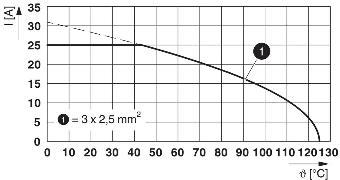
$I$  = intensité,  $\vartheta$  = température ambiante, 3x 25 A
