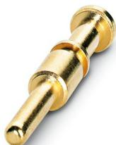
Contact à sertir, Mâle, tournés, diamètre de contact: 2 mm, zone de sertissage: 0,25 mm<sup>2</sup> ... 1 mm<sup>2</sup>, Produit de remplacement selon RoHS II sans exception 6c (Pb < 0,1 %) référence : 1242329
