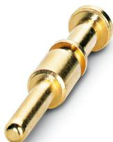
Contact à sertir, Mâle, tournés, Contact unique, diamètre de contact: 2 mm, zone de sertissage: 1 mm<sup>2</sup> ... 2,5 mm<sup>2</sup>, Produit de remplacement selon RoHS II sans exception 6c (Pb < 0,1 %) référence : 1242329
