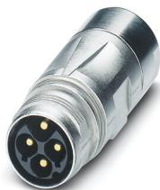
Connecteur prolongateur, droit, Pour verrouillage standard et SPEEDCON, M17, nombre de pôles: 5+PE, type de contact: Mâle, blindé: oui, indice de protection: IP67, plage de diamètre de câble: 9 mm ... 11,2 mm, nombre de pôles: 6, type de raccordement: Raccordement à sertir, série: ST, Produit de remplacement selon RoHS II sans exception 6c (Pb < 0,1 %) référence : 1243286
