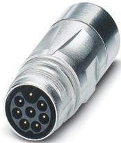
Connecteur prolongateur, droit, Pour verrouillage standard et SPEEDCON, M17, nombre de pôles: 5+3+PE, type de contact: Mâle, blindé: oui, cote de bride: 25,75 mm x 25,75 mm, indice de protection: IP67, plage de diamètre de câble: 5 mm ... 9,2 mm, nombre de pôles: 9, type de raccordement: Raccordement à sertir, série: ST, Produit de remplacement selon RoHS II sans exception 6c (Pb < 0,1 %) référence : 1243305
