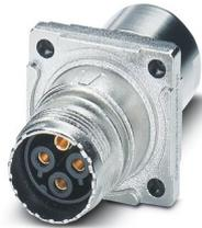
Traversée de paroi, droit, SPEEDCONN, M17, nombre de pôles: 3+PE, type de contact: Connecteur femelle, Joint plat, 4x Ø 3,2, blindé: oui, cote de bride: 25,75 mm x 25,75 mm, indice de protection: IP67, plage de diamètre de câble: 5 mm ... 9 mm, nombre de pôles: 4, type de raccordement: Raccordement à sertir, série: ST, Produit de remplacement selon RoHS II sans exception 6c (Pb < 0,1 %) référence : 1243315
