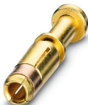
Contact à sertir, Connecteur femelle, tournés, Contact unique, diamètre de contact: 2 mm, zone de sertissage: 1 mm<sup>2</sup> ... 2,5 mm<sup>2</sup>, Produit de remplacement selon RoHS II sans exception 6c (Pb < 0,1 %) référence : 1237423
