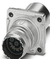
Traversée de paroi, droit, SPEEDCONNEC, M17, nombre de pôles: 8, type de contact: Connecteur femelle, Joint plat, 4x Ø 3,2, blindé: oui, cote de bride: 25,75 mm x 25,75 mm, indice de protection: IP67, plage de diamètre de câble: 5 mm ... 9 mm, nombre de pôles: 8, type de raccordement: Raccordement à sertir, série: ST, Produit de remplacement selon RoHS II sans exception 6c (Pb < 0,1 %) référence : 1243336
