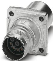
Traversée de paroi, droit, SPEEDCONNEC, M17, nombre de pôles: 17, type de contact: Connecteur femelle, Joint plat, 4x Ø 3,2, blindé: oui, cote de bride: 25,75 mm x 25,75 mm, indice de protection: IP67, plage de diamètre de câble: 5 mm ... 9 mm, nombre de pôles: 17, type de raccordement: Raccordement à sertir, série: ST, Produit de remplacement selon RoHS II sans exception 6c (Pb < 0,1 %) référence : 1243346
