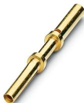
Contact à sertir, Connecteur femelle, tournés, diamètre de contact: 0,6 mm, zone de sertissage: 0,14 mm<sup>2</sup> ... 0,34 mm<sup>2</sup>, Produit de remplacement selon RoHS II sans exception 6c (Pb < 0,1 %) référence : 1242314
