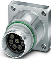
Embases paroi avant, droit, Pour verrouillage standard et SPEEDCON, M17, nombre de pôles: 7+PE, type de contact: Connecteur femelle, Joint torique axial, 4x Ø 3,2, blindé: oui, cote de bride: 25,75 mm x 25,75 mm, indice de protection: IP67, nombre de pôles: 8, type de raccordement: Raccordement à sertir, série: ST
