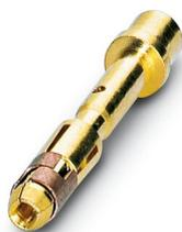
Contact à sertir, Connecteur femelle, tournés, Contact unique, diamètre de contact: 1 mm, zone de sertissage: 0,06 mm<sup>2</sup> ... 0,25 mm<sup>2</sup>, Produit de remplacement selon RoHS II sans exception 6c (Pb < 0,1 %) référence : 1243216
