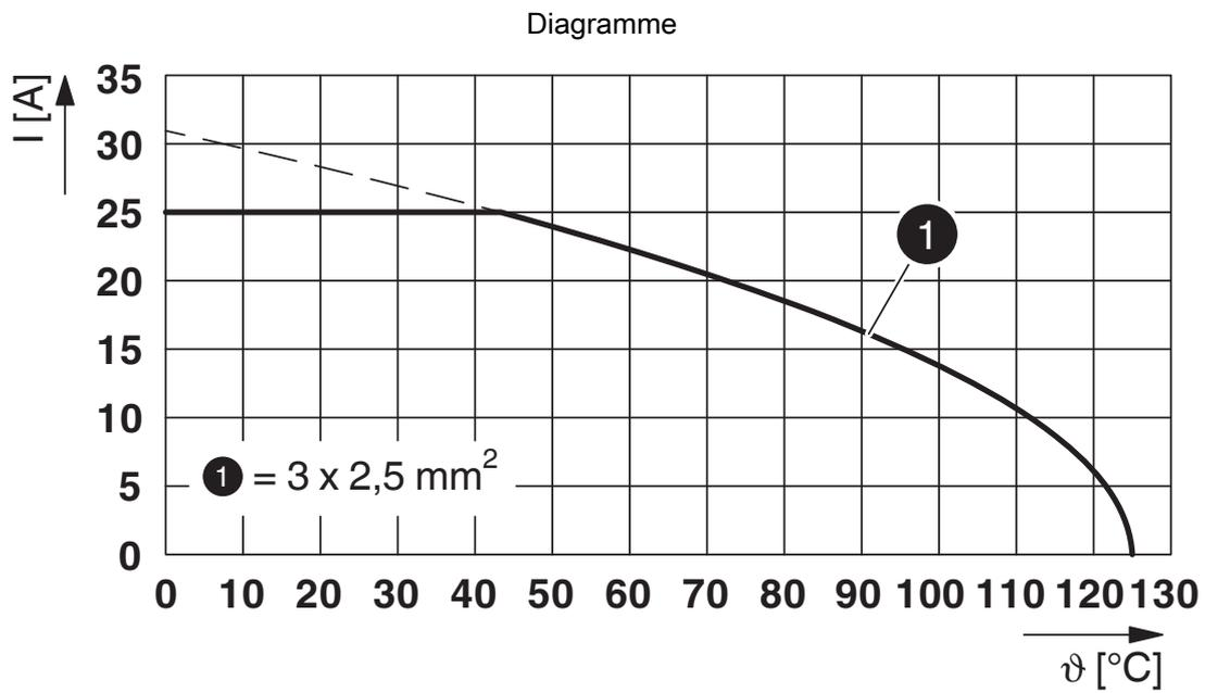
$I$  = intensité,  $\vartheta$  = température ambiante, 3x 25 A
