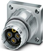
Embases paroi avant, droit, Pour verrouillage standard et SPEEDCON, M17, nombre de pôles: 3+PE, type de contact: Mâle, Joint torique axial, 4x Ø 3,2, blindé: oui, cote de bride: 25,75 mm x 25,75 mm, indice de protection: IP67, nombre de pôles: 4, type de raccordement: Raccordement à sertir, série: ST
