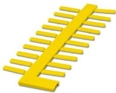
Etiquette, Rubans, jaune, vierge, repérable avec : CMS-P1-PLOTTER, type de montage: enfilage, plage de diamètre de câble: 0,6 ... 50 mm, surface utile: 15 x 4 mm, Nombre d'étiquettes: 20
