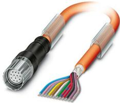
Connecteur de câble à enrobage plastique par extrusion, droit, surmoulé, nombre de pôles: 12, Type de verrouillage: Verrouillage à vis, longueur de câble: 2 m, blindé: oui, coloris de la gaine extérieure: orange RAL 2003
