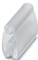
Repères pour fils, transparent, vierge, type de montage: enfilage, plage de diamètre de câble: 6 ... 10 mm, surface utile: 23 x 4 mm
