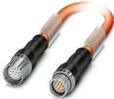
Connecteur bilatéral à enrobage plastique par extrusion, droit, surmoulé, nombre de pôles: 12, Type de verrouillage: Verrouillage à vis, droit, surmoulé, blindé: oui, coloris de la gaine extérieure: orange RAL 2003
