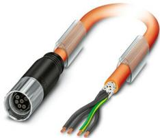
Connecteur de câble à enrobage plastique par extrusion, série: KST, M17-Connecteur femelle, droit, surmoulé, nombre de pôles: 5+PE, Type de verrouillage: Verrouillage à vis, longueur de câble: 2 m, blindé: oui, Produit de remplacement selon RoHS II sans exception 6c (Pb < 0,1 %) référence : 1243432
