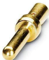
Contact à sertir, Mâle, tournés, Contact unique, diamètre de contact: 1 mm, zone de sertissage: 0,5 mm<sup>2</sup> ... 1 mm<sup>2</sup>, Produit de remplacement selon RoHS II sans exception 6c (Pb < 0,1 %) référence : 1241571
