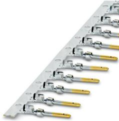
Contact à sertir, Mâle, roulés, Produits en bande, nombre de pièces par bande: 500, diamètre de contact: 1 mm, zone de sertissage: 0,08 mm<sup>2</sup> ... 0,22 mm<sup>2</sup>
