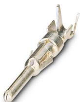
Contact à sertir, Mâle, roulés, Contact unique, diamètre de contact: 1 mm, zone de sertissage: 0,22 mm<sup>2</sup> ... 0,56 mm<sup>2</sup>, Contact individuel, L'article est sans plomb, conformément à la directive RoHS II, sans exception 6c (Pb < 0,1 %)
