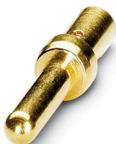
Contact à sertir, Mâle, tournés, diamètre de contact: 2 mm, zone de sertissage: 1 mm<sup>2</sup> ... 1,5 mm<sup>2</sup>, Produit de remplacement selon RoHS II sans exception 6c (Pb < 0,1 %) référence : 1241634
