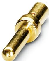
Contact à sertir, Mâle, tournés, diamètre de contact: 2 mm, zone de sertissage: 1,5 mm<sup>2</sup> ... 2,5 mm<sup>2</sup>, Produit de remplacement selon RoHS II sans exception 6c (Pb < 0,1 %) référence : 1241634
