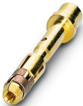
Contact à sertir, Connecteur femelle, tournés, Contact unique, diamètre de contact: 1 mm, zone de sertissage: 0,25 mm<sup>2</sup> ... 1 mm<sup>2</sup>, Produit de remplacement selon RoHS II sans exception 6c (Pb < 0,1 %) référence : 1241922
