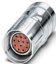
M23, Connecteurs à câble, série: CA, droit, blindé: oui, SPEEDCONNNEC, Nombre de pôles: 17, Sens de rotation: standard, type de contact: Connecteur femelle, Raccordement à sertir, plage de diamètre de câble: 10 mm ... 14,5 mm, détrompage: N, Produit de remplacement selon RoHS II sans exception 6c (Pb < 0,1 %) référence : 1243570
