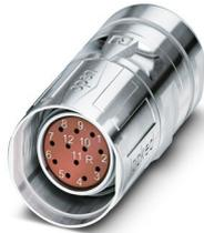
M23, Connecteurs à câble, série: CA, droit, blindé: oui, SPEEDCONNEC, Nombre de pôles: 12, Sens de rotation: standard, type de contact: Connecteur femelle, Raccordement à sertir, plage de diamètre de câble: 6 mm ... 10 mm, détrompage: N, Produit de remplacement selon RoHS II sans exception 6c (Pb < 0,1 %) référence : 1243578
