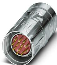
M23, Connecteurs à câble, série: CA, droit, blindé: oui, SPEEDCONNNEC, Nombre de pôles: 12, Sens de rotation: inversé, type de contact: Mâle, Raccordement à sertir, plage de diamètre de câble: 6 mm ... 10 mm, détrompage: N, Produit de remplacement selon RoHS II sans exception 6c (Pb < 0,1 %) référence : 1243579
