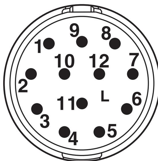
Numérotation des chambres de contact (vue côté connecteur) connecteur mâle inversé
