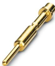
Contact à sertir, Mâle, tournés, Contact unique, diamètre de contact: 1 mm, zone de sertissage:  $0,06 \text{ mm}^2 \dots 0,25 \text{ mm}^2$ , Produit de remplacement selon RoHS II sans exception 6c ( $\text{Pb} < 0,1 \%$ ) référence : 1241921
