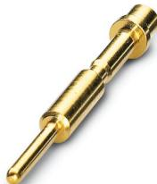
Contact à sertir, Mâle, tournés, Contact unique, diamètre de contact: 1 mm, zone de sertissage: 0,25 mm<sup>2</sup> ... 1 mm<sup>2</sup>, Produit de remplacement selon RoHS II sans exception 6c (Pb < 0,1 %) référence : 1241921
