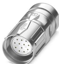
M23, Connecteurs à câble, série: CA, droit, blindé: oui, SPEEDCONNEC, Nombre de pôles: 12, Sens de rotation: standard, type de contact: Connecteur femelle, Raccordement à sertir, plage de diamètre de câble: 4 mm ... 6 mm, détrompage: N, Produit de remplacement selon RoHS II sans exception 6c (Pb < 0,1 %) référence : 1243656
