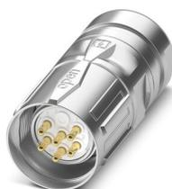
M23, Connecteurs à câble, série: CA, droit, blindé: oui, SPEEDCONNEC, Nombre de pôles: 8+1, Sens de rotation: standard, type de contact: Mâle, Raccordement à sertir, plage de diamètre de câble: 4 mm ... 6 mm, détrompage: N, Produit de remplacement selon RoHS II sans exception 6c (Pb < 0,1 %) référence : 1243659
