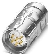
M23, Connecteurs à câble, série: CA, droit, blindé: oui, SPEEDCONNÉC, Nombre de pôles: 6, Sens de rotation: standard, type de contact: Mâle, Raccordement à sertir, plage de diamètre de câble: 4 mm ... 6 mm, détrompage: N, Produit de remplacement selon RoHS II sans exception 6c (Pb < 0,1 %) référence : 1243667
