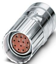
M23, Connecteurs à câble, série: CA, droit, blindé: oui, Verrouillage à vis, Nombre de pôles: 12, Sens de rotation: inversé, type de contact: Connecteur femelle, Raccordement à sertir, plage de diamètre de câble: 10 mm ... 14,5 mm, détrompage: N, Produit de remplacement selon RoHS II sans exception 6c (Pb < 0,1 %) référence : 1243703
