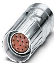
M23, Connecteurs à câble, série: CA, droit, blindé: oui, Verrouillage à vis, Nombre de pôles: 12, Sens de rotation: standard, type de contact: Connecteur femelle, Raccordement à sertir, plage de diamètre de câble: 3 mm ... 14,5 mm, détrompage: N, Produit de remplacement selon RoHS II sans exception 6c (Pb < 0,1 %) référence : 1243720
