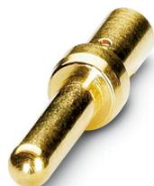
Contact à sertir, Mâle, tournés, Contact unique, diamètre de contact: 1 mm, zone de sertissage: 0,08 mm<sup>2</sup> ... 0,22 mm<sup>2</sup>, Produit de remplacement selon RoHS II sans exception 6c (Pb < 0,1 %) référence : 1240882
