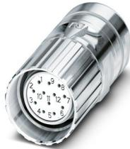
M23, Connecteurs à câble, série: CA, droit, blindé: oui, Verrouillage à vis, Nombre de pôles: 12, Sens de rotation: standard, type de contact: Connecteur femelle, Raccordement soudé, plage de diamètre de câble: 6 mm ... 10 mm, détrompage: N, Produit de remplacement selon RoHS II sans exception 6c (Pb < 0,1 %) référence : 1243762
