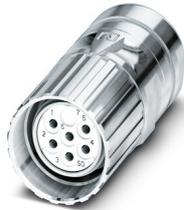
M23, Connecteurs à câble, série: CA, droit, blindé: oui, Verrouillage à vis, Nombre de pôles: 6, Sens de rotation: standard, type de contact: Connecteur femelle, Raccordement à sertir, plage de diamètre de câble: 6 mm ... 10 mm, détrompage: N, Produit de remplacement selon RoHS II sans exception 6c (Pb < 0,1 %) référence : 1243774
