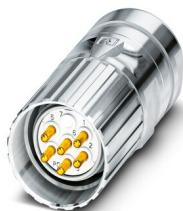
M23, Connecteurs à câble, série: CA, droit, blindé: oui, Verrouillage à vis, Nombre de pôles: 8+1, Sens de rotation: standard, type de contact: Mâle, Raccordement soudé, plage de diamètre de câble: 4 mm ... 6 mm, détrompage: N, Produit de remplacement selon RoHS II sans exception 6c (Pb < 0,1 %) référence : 1243793
