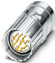
M23, Connecteurs à câble, série: CA, droit, blindé: oui, Verrouillage à vis, Nombre de pôles: 17, Sens de rotation: standard, type de contact: Mâle, Raccordement soudé, plage de diamètre de câble: 3 mm ... 14,5 mm, détrompage: N, Produit de remplacement selon RoHS II sans exception 6c (Pb < 0,1 %) référence : 1243807
