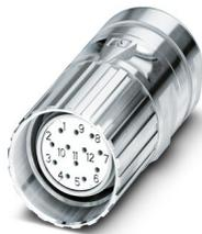
M23, Connecteurs à câble, série: CA, droit, blindé: oui, Verrouillage à vis, Nombre de pôles: 12, Sens de rotation: standard, type de contact: Connecteur femelle, Raccordement à sertir, plage de diamètre de câble: 3 mm ... 14,5 mm, détrompage: N, Produit de remplacement selon RoHS II sans exception 6c (Pb < 0,1 %) référence : 1243814
