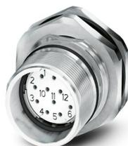
M23, Connecteur d'appareil face arrière, série: CA, droit, blindé: oui, Pour verrouillage standard et SPEEDCON, Nombre de pôles: 12, Sens de rotation: standard, type de contact: Connecteur femelle, Raccordement à sertir, Joint axial, Fixation centrale, détrompage: N, Produit de remplacement selon RoHS II sans exception 6c (Pb < 0,1 %) référence : 1243840
