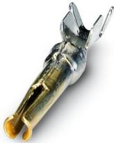
Contact à sertir, Connecteur femelle, roulés, Contact unique, diamètre de contact: 1 mm, zone de sertissage: 0,22 mm<sup>2</sup> ... 0,56 mm<sup>2</sup>, Contact individuel, L'article est sans plomb, conformément à la directive RoHS II, sans exception 6c (Pb < 0,1 %)
