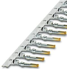
Contact à sertir, Connecteur femelle, roulés, Produits en bande, nombre de pièces par bande: 500, diamètre de contact: 1 mm, zone de sertissage: 0,22 mm<sup>2</sup> ... 0,56 mm<sup>2</sup>, L'article est sans plomb, conformément à la directive RoHS II, sans exception 6c (Pb < 0,1 %)
