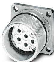
M23, Embases paroi avant, série: CA, droit, blindé: oui, Pour verrouillage standard et SPEEDCON, Nombre de pôles: 6, Sens de rotation: standard, type de contact: Connecteur femelle, Raccordement soudé, Joint plat, 4x Ø 3,2, cote de bride: 25 mm x 25 mm, détrompage: N, Produit de remplacement selon RoHS II sans exception 6c (Pb < 0,1 %) référence : 1243894
