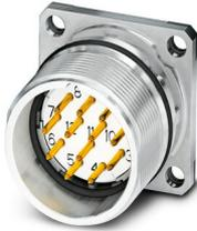
M23, Embases paroi avant, série: CA, droit, blindé: oui, Pour verrouillage standard et SPEEDCON, Nombre de pôles: 16, Sens de rotation: standard, type de contact: Mâle, Raccordement soudé, Joint plat, 4x Ø 3,2, cote de bride: 25 mm x 25 mm, détrompage: N
