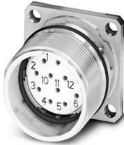
M23, Embases paroi avant, série: CA, droit, blindé: oui, Pour verrouillage standard et SPEEDCON, Nombre de pôles: 12, Sens de rotation: standard, type de contact: Connecteur femelle, Raccordement à sertir, Joint plat, 4x Ø 3,2, cote de bride: 25 mm x 25 mm, détrompage: N
