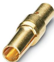
Contact à sertir, Connecteur femelle, tournés, diamètre de contact: 2 mm, zone de sertissage: 1 mm<sup>2</sup> ... 1,5 mm<sup>2</sup>, Produit de remplacement selon RoHS II sans exception 6c (Pb < 0,1 %) référence : 1241635
