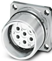
M23, Embases paroi avant, série: CA, droit, blindé: oui, Pour verrouillage standard et SPEEDCON, Nombre de pôles: 7, Sens de rotation: standard, type de contact: Connecteur femelle, Raccordement à sertir, Joint plat, 4x Ø 3,2, cote de bride: 25 mm x 25 mm, détrompage: N
