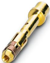
Contact à sertir, Connecteur femelle, tournés, Contact unique, diamètre de contact: 1 mm, zone de sertissage: 0,25 mm<sup>2</sup> ... 1 mm<sup>2</sup>, Produit de remplacement selon RoHS II sans exception 6c (Pb < 0,1 %) référence : 1241922
