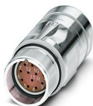
M23, Connecteur prolongateur, série: CA, droit, blindé: oui, Pour verrouillage standard et SPEEDCON, Nombre de pôles: 12, Sens de rotation: standard, type de contact: Connecteur femelle, Raccordement à sertir, plage de diamètre de câble: 3 mm ... 14,5 mm, détrompage: N, Produit de remplacement selon RoHS II sans exception 6c (Pb < 0,1 %) référence : 1243954
