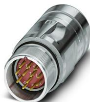
M23, Connecteur prolongateur, série: CA, droit, blindé: oui, Pour verrouillage standard et SPEEDCON, Nombre de pôles: 12, Sens de rotation: inversé, type de contact: Mâle, Raccordement à sertir, plage de diamètre de câble: 3 mm ... 14,5 mm, détrompage: N, Produit de remplacement selon RoHS II sans exception 6c (Pb < 0,1 %) référence : 1243955
