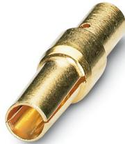
Contact à sertir, Connecteur femelle, tournés, Contact unique, diamètre de contact: 1 mm, zone de sertissage: 0,5 mm<sup>2</sup> ... 1 mm<sup>2</sup>, Produit de remplacement selon RoHS II sans exception 6c (Pb < 0,1 %) référence : 1241572
