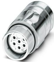
M23, Connecteur prolongateur, série: CA, droit, blindé: oui, Pour verrouillage standard et SPEEDCON, Nombre de pôles: 7, Sens de rotation: standard, type de contact: Connecteur femelle, Raccordement à sertir, plage de diamètre de câble: 10 mm ... 14,5 mm, détrompage: N, Produit de remplacement selon RoHS II sans exception 6c (Pb < 0,1 %) référence : 1243976
