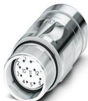
M23, Connecteur prolongateur, série: CA, droit, blindé: oui, Pour verrouillage standard et SPEEDCON, Nombre de pôles: 16, Sens de rotation: standard, type de contact: Connecteur femelle, Raccordement à sertir, plage de diamètre de câble: 4 mm ... 6 mm, détrompage: N, Produit de remplacement selon RoHS II sans exception 6c (Pb < 0,1 %) référence : 1244017
