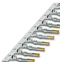
Contact à sertir, Connecteur femelle, roulés, Produits en bande, nombre de pièces par bande: 500, diamètre de contact: 1 mm, zone de sertissage: 0,22 mm<sup>2</sup> ... 0,56 mm<sup>2</sup>, L'article est sans plomb, conformément à la directive RoHS II, sans exception 6c (Pb < 0,1 %)
