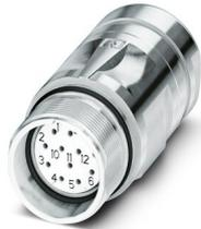
M23, Connecteur prolongateur, série: CA, droit, blindé: oui, Pour verrouillage standard et SPEEDCON, Nombre de pôles: 17, Sens de rotation: standard, type de contact: Connecteur femelle, Raccordement à sertir, plage de diamètre de câble: 3 mm ... 14,5 mm, détrompage: N, Produit de remplacement selon RoHS II sans exception 6c (Pb < 0,1 %) référence : 1244039
