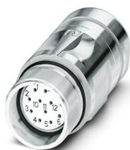
M23, Connecteur prolongateur, série: CA, droit, blindé: oui, Pour verrouillage standard et SPEEDCON, Nombre de pôles: 12, Sens de rotation: standard, type de contact: Connecteur femelle, Raccordement à sertir, plage de diamètre de câble: 3 mm ... 14,5 mm, détrompage: N, Produit de remplacement selon RoHS II sans exception 6c (Pb < 0,1 %) référence : 1244047
