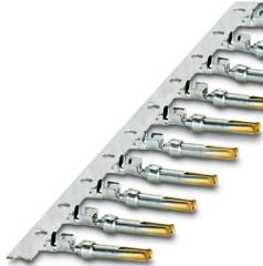
Contact à sertir, Connecteur femelle, roulés, Produits en bande, nombre de pièces par bande: 10000, diamètre de contact: 1 mm, zone de sertissage: 0,22 mm<sup>2</sup> ... 0,56 mm<sup>2</sup>, L'article est sans plomb, conformément à la directive RoHS II, sans exception 6c (Pb < 0,1 %)
